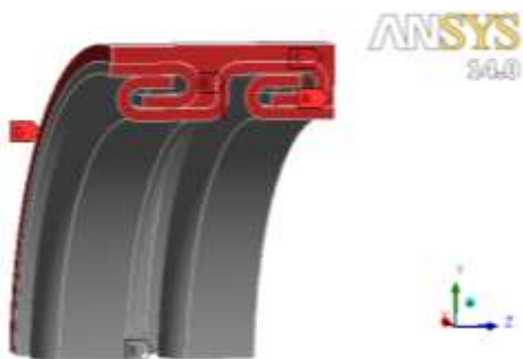
Figura 10. Carregamento e condições de contorno
