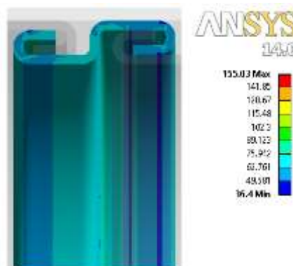
Figura 19. Tensão equivalente de von Mises para o modelo simplificado com pressão de 10MPa
