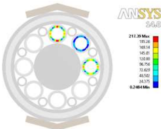
Figura 523. Tensão de von Mises nos diâmetros internos
